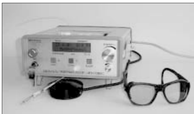
Рис. 2. Лазерный скальпель «ЛС-0,97-«ИРЭ-Полус»
