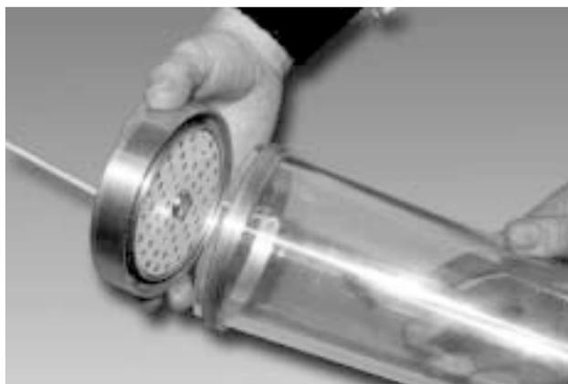
Рис. 2. Фотоматричная система и вакуумная насадка.
