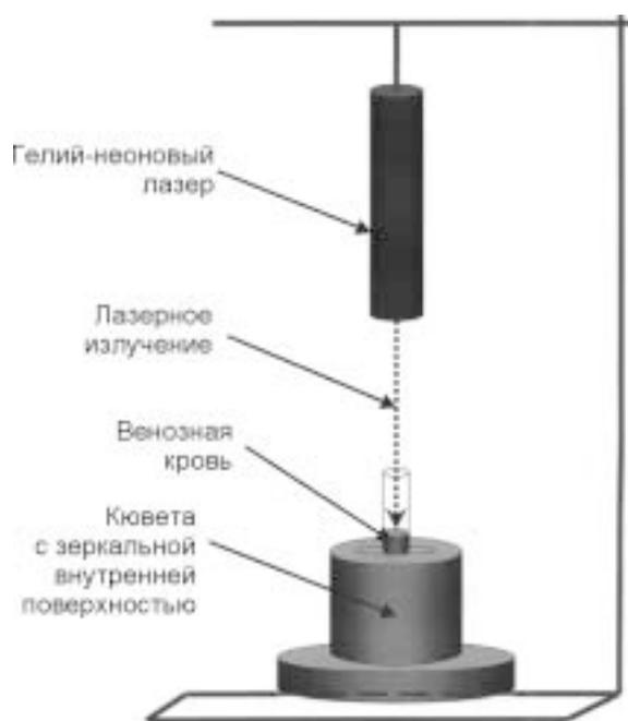
Рис. 2. Схема устройства для лазерного облучения крови. Кровь находится в стеклянной пробирке, размещенной в стальной кювете с зеркальной внутренней поверхностью.
