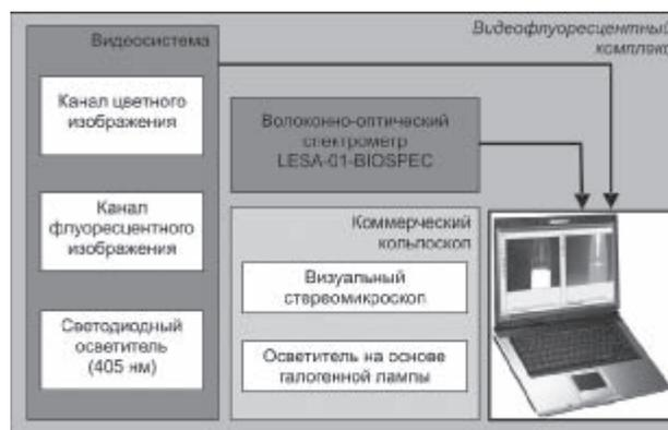
Рис. 3. Структура видеофлуоресцентного комплекса
