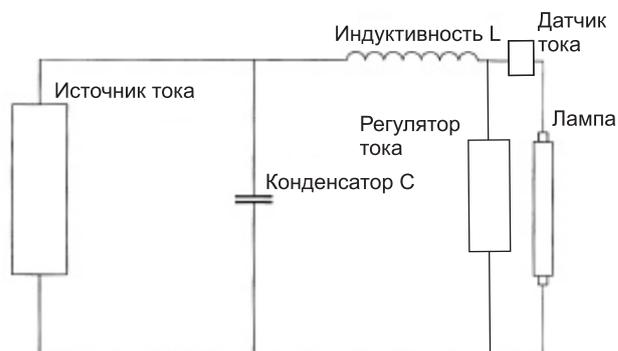
Рис. 2. Схема разрядного контура
